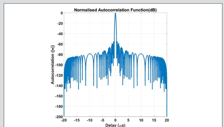
(d) - Normalized ACF for  $T=20ms$ ,  $B=10MHz$
